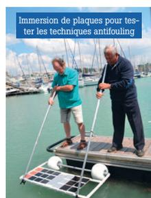
Immersion de plaques pour tester les techniques antifouling
